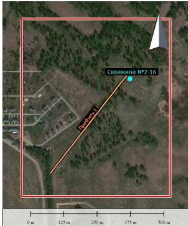
Рисунок 80 – Фрагмент спутникового снимка с очерченной границей участка (красная линия), геофизическим профилем (оранжевая линия) и точкой бурения водозаборной скважины (голубой кружок).
