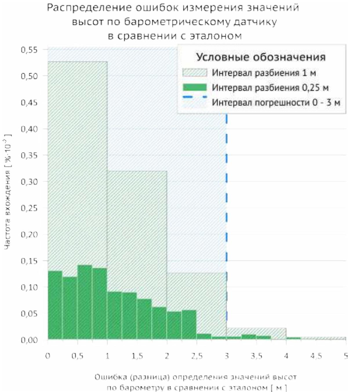
**Рисунок 54** – Статистика распределения ошибок определения высот по барометру в сравнении с эталоном. Гистограмма наглядно показывает, что 97% точек лежат в интервале ошибки 0-3 м, 84,5% - в интервале 0-2 м, а более половины точек повторяют рельеф дневной поверхности с точностью лучше 1 метра.
