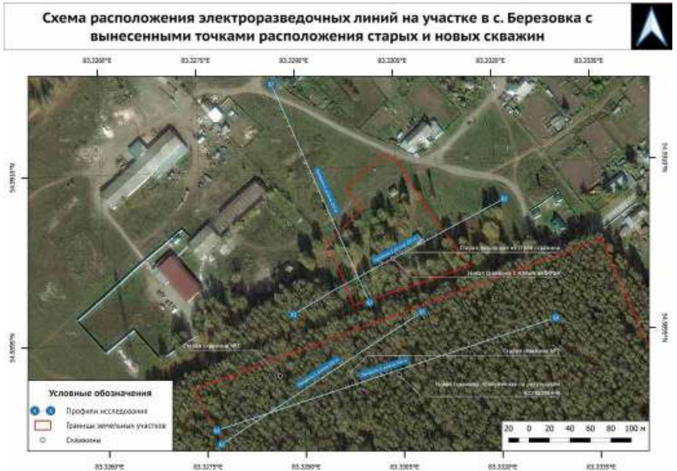
**Рисунок 87** – Схема расположения электроразведочных профилей на участках исследования в с. Березовка с вынесенными точками водозаборных скважин.
