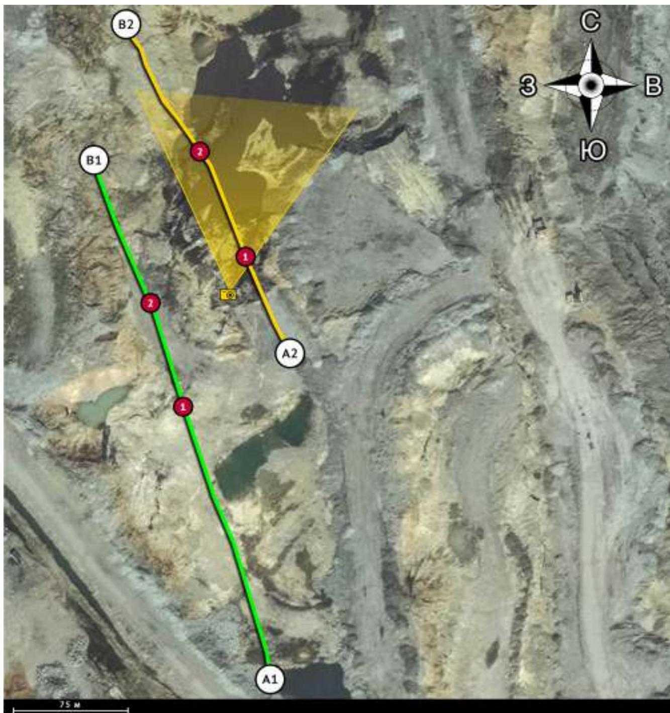
Рисунок 110 – Западный участок. Профили 1 и 2 обозначены зеленой и желтой линией, соответственно. Желтым значком фотоаппарата отмечена точка съемки фотографии, представленной на рисунке 111. Красные кружки с цифрами – точки, вынесенные на геоэлектрические разрезы на рисунках 112 и 114. Разрез Барзасский, Кемеровская область.
