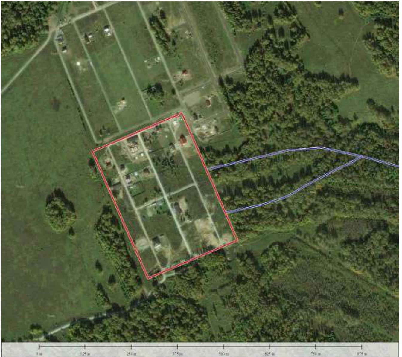
Рисунок 64 – Фрагмент спутникового снимка с очерченным участком работ (красная граница), а также схематическим изображением (синие линии) путей миграции поверхностного стока через примыкающие с востока балки.
