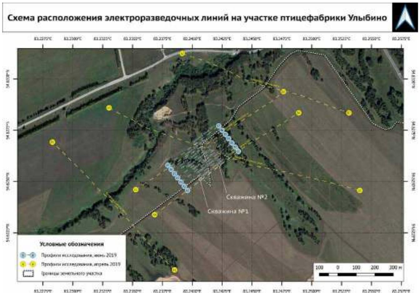
Рисунок 93 – План участка работ с нанесенными профилями исследования. Основная серия – желтые пунктирные линии. Уточняющая серия – светло-синие.
